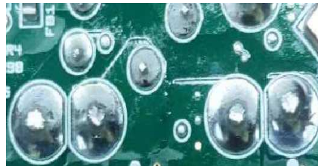
涌流焊接方式：焊接面無殘留
